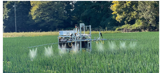
図：自律自走式農薬散布ロボット（レグミン社製）
