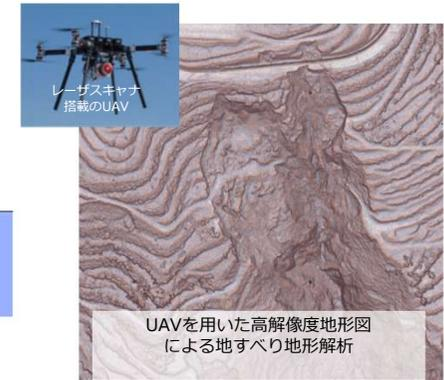
UAVを用いた高解像度地形図による地すべり地形解析
