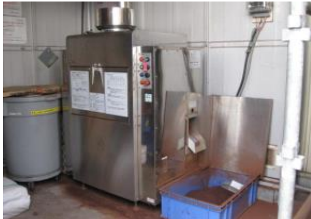
リサイクラー（ヒーター加熱、温風乾燥方式）
