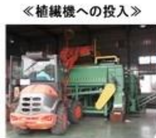
《植纖機への投入》 バケットローダーを使って 植纖機へ投入
