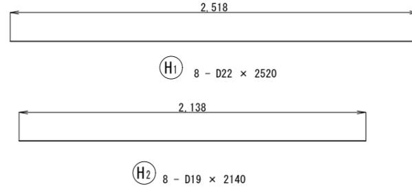
開口部補強筋詳細図
