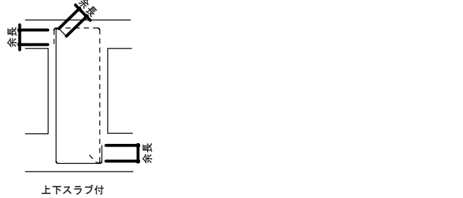
図2-3-6 副あばら筋・副帯筋の形状
