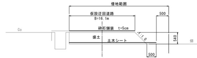
盛土量  $V = 1/2 \times (\text{下面積} + \text{上面積}) \times \text{高さ} = 97.5\text{m}^3$
