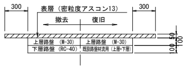
仮舗装断面図 (県道) S=1:25
