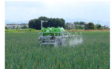
ねぎの自動農薬散布ロボット
