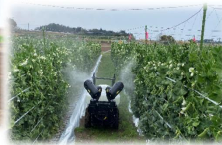
無人自動運転散布車両 による防除
