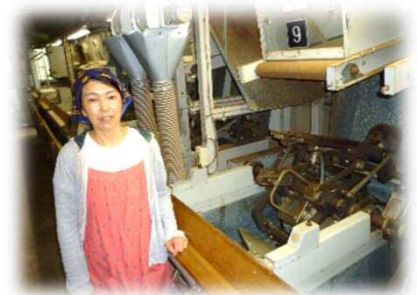
精揉機（せいじゅうき） お茶の葉を細くなるように揉みながら乾燥させます
