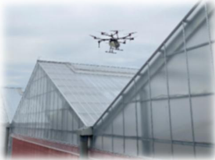
ドローンによる遮光剤塗布
