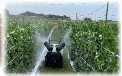
無人自動運転散布車両 による防除
