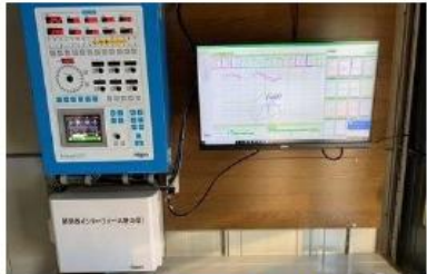
施設園芸:統合環境制御装置
