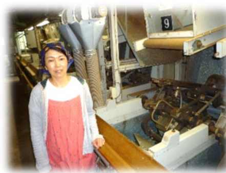
精揉機（せいじゅうき） お茶の葉を細くなるように揉みながら乾燥させます
