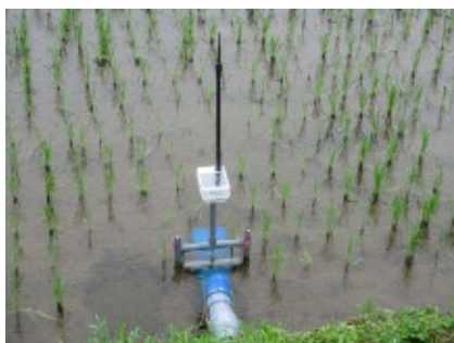
【給水ゲート】 ・水位を設定すれば自動給水 ・スマホから直接指示も可能
