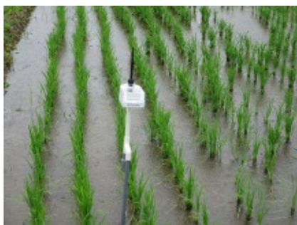
【水田ファーム(水位センサ)】 水位を測定しデータを通信機へ送信
