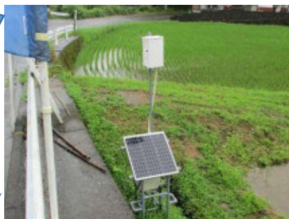
【中継通信機】 ・水位センサからのデータをスマホへ転送 ・スマホから給水ゲートの開閉指示を受信し、給水ゲートへ転送
