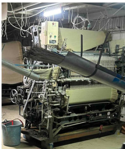
い草生産農家の 冠水した織機の修繕
