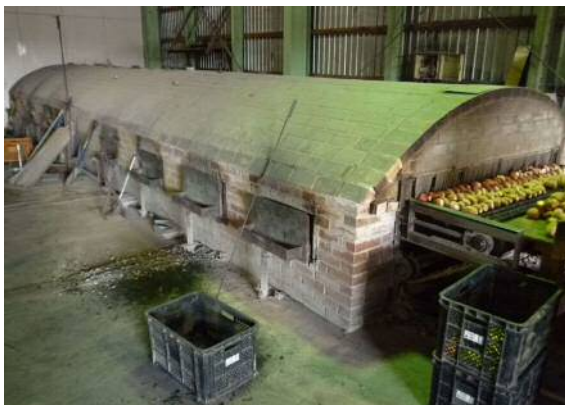
自社開発の炭火焼き芋釜。2時間かけてローストされ焼き芋となる
