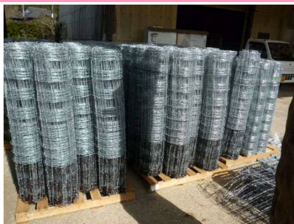
シカ対策用の金属ネット柵。シカが飛び越えることが出来ない高さとしている
