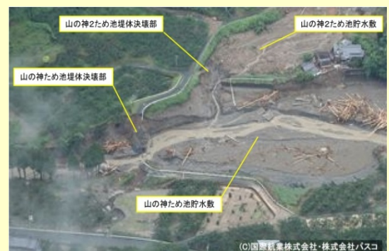
堤体や洪水吐が決壊した福岡県朝倉市の山の神ため池
