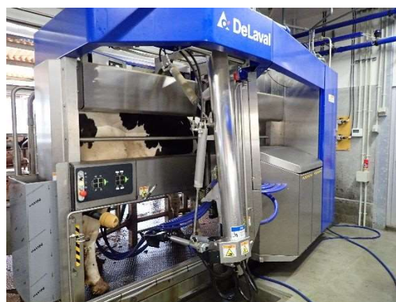
酪農経営の労働負担軽減を図る搾乳ロボット
