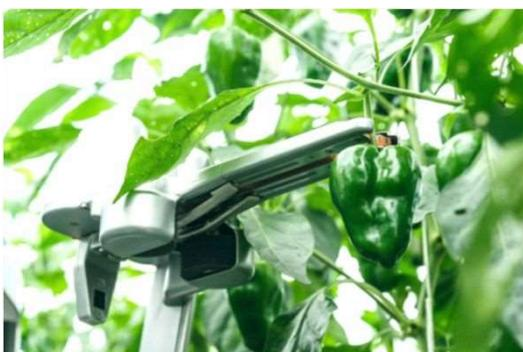
AIにより多関節アームが最適な角度からアプローチを行い、安心・安全・確実にピーマンを収穫
