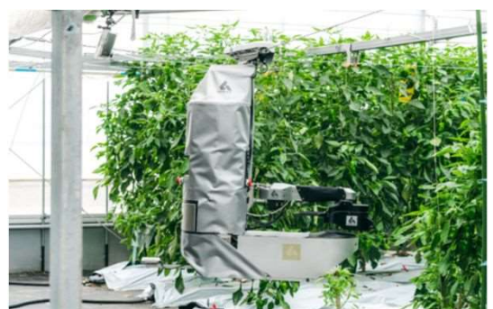
ロボットがハウス内に張られたワイヤーを辿りながら移動しピーマンを収穫する
