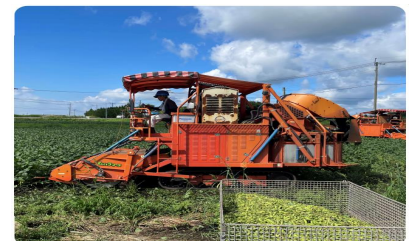
『機械化』お茶の収穫機を改造したエダマメの収穫機
