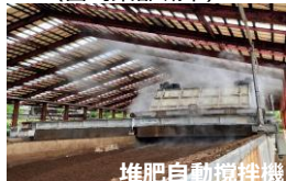
堆肥自動攪拌機
