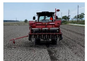
グレンドリル（トラクターに装着する播種機）による直播作業
