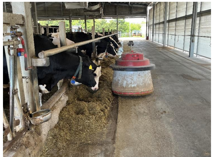
酪農経営の労働負担軽減を図る餌寄せロボット
