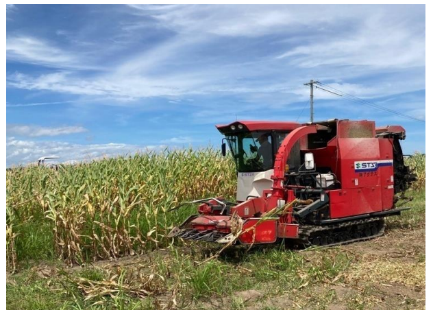
汎用型飼料収穫機による 青刈りとうもろこしの収穫作業
