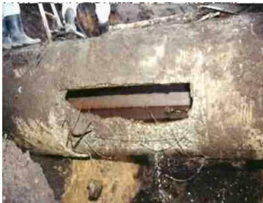
管破損による漏水 (幹線水路)
