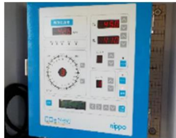
ハウス複合環境制御装置 (高速高濃度CO2センサ)
