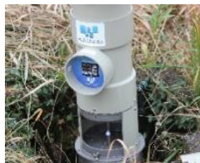
自動・遠隔操作水管理システム
