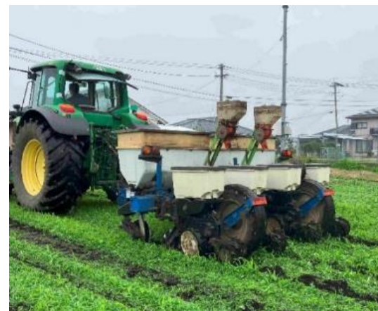
ガイダンスシステム自動操舵によるコーン、大豆の播種
