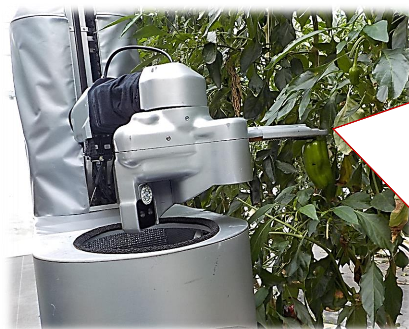
独自に開発したベルト式の収穫ハンドによるピーマンの収穫
