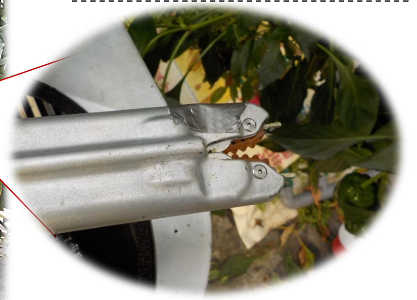
独自に開発したベルト式の収穫ハンドによるピーマンの収穫
