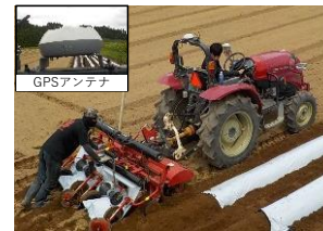
自動操舵システムを用いた畝立作業
