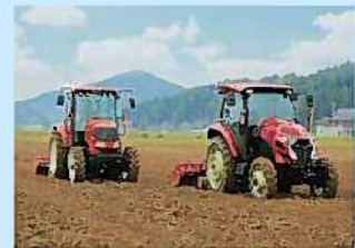
▲自動運転トラクタによる耕うんと自動操舵システム付きトラクタによる播種作業
