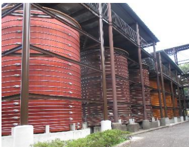
【国産スギ材製の大型醸造樽】
