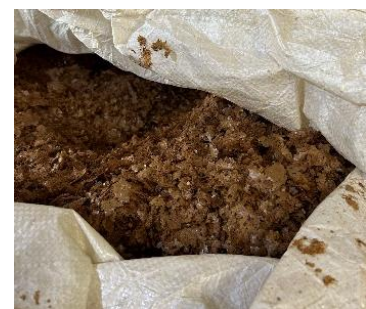
【蒸気乾燥された脱水汚泥】
