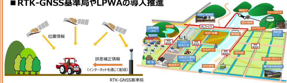
RTK-GNSS基準局の導入
