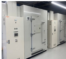
様々な環境条件を実現し、作物の反応を計測する「ロボティクス人工気象室」
