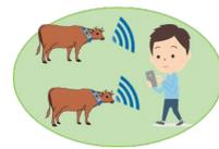
放牧牛に電子タグを装着。場内の水飲み場等に設置した受信機に牛が近づくと検知。
