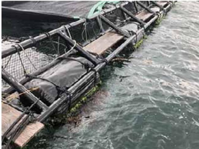
生分解性プラスチックを用いたフロートの試作品と実証試験
