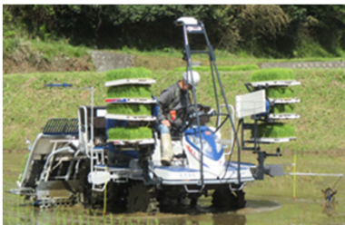
化学肥料の施肥量を減少させる 土壌センサ付可変施肥田植機
