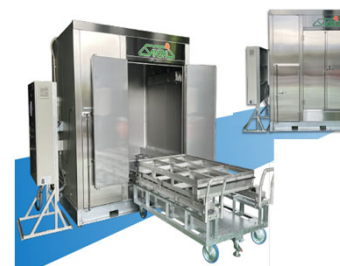
基腐病用蒸熱處理裝置
