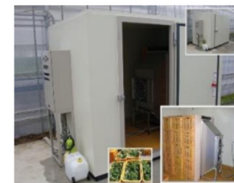
蒸熱処理装置
