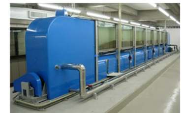
大型回流水槽（水産技術研究所）
