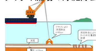
バケット浚渫による浮泥除去
