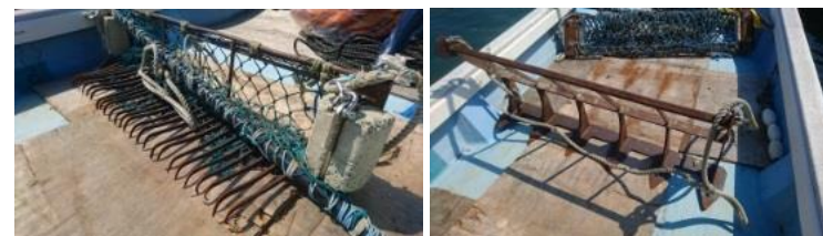
底質攪拌で使用する器具 左:貝桁(既存器具)、右:改良器具(H28製作)
