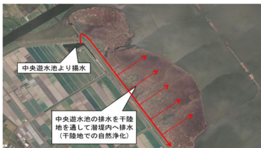
図 3-11 ヨシ原を活用した干拓地排水の浄化対策イメージ
