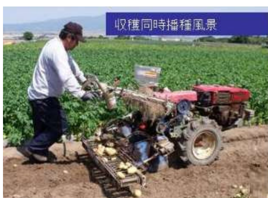
写真 3-15 緑肥播種装置を搭載したバレイショ収穫機
