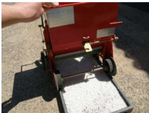
写真 3-12 手動式播種機による 育苗箱への施肥
