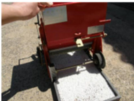
写真 3-9 育苗箱全量施肥栽培技術(左は手動式の施肥機、右は成長した苗の根元)
