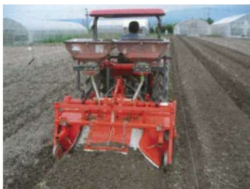
写真 3-5 畦内施肥機による施肥と畦立ての同時作業
