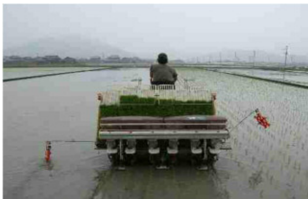
写真 3-8 側条施肥機による田植えの状況
