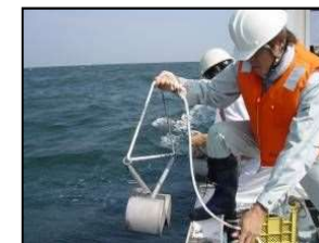
採泥器による採泥状況 (底質攪拌調査)
