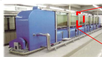
大型回流水槽（水産技術研究所）を用いた稚貝捕捉機構解明
