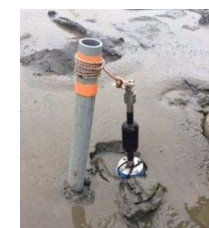
流速計設置状況
